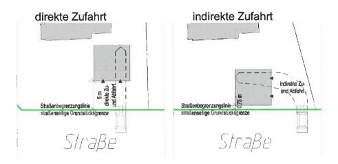
Um die Leichtigkeit des Verkehrs zu erhalten und die barrierefreie Zufahrtsmöglichkeit zu den Garagen, Carports und Stellplätzen zu erhöhen, wird eine Einfriedung im Bereich vor Zu- und Ausfahrten von und auf die Grundstücke verboten.
